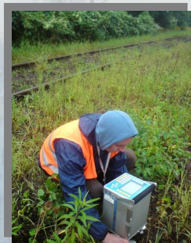
Rys. 5 Pomiar metodą mikrogravimetryczną
