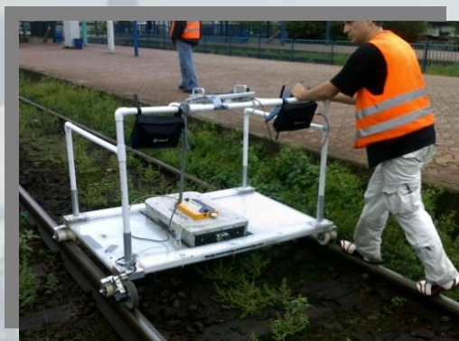
Rys.3 System jednorodowej anteny na wózku ręcznym
