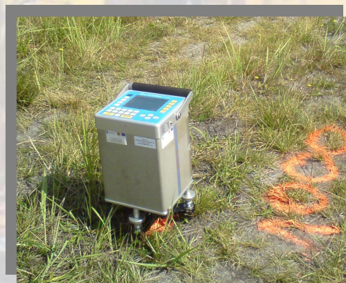
Rys. 3 Pomiar grawimetryczny na punkcie bazowym nr 1000
